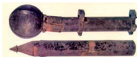
Øverst en raket med en bombe i spidsen. Nederst en af Congreves raketter med modhager i spidsen, så den kunne sætte sig fast, hvor den ramte. Orlogsmuseet.
